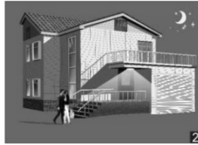
Rörelsedetektor tänder armaturen när det är mörkt ute.
