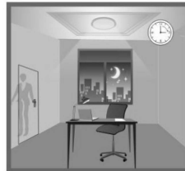
Efter en viss tid utan rörelse i rummet sänks ljusflödet från armaturen.
